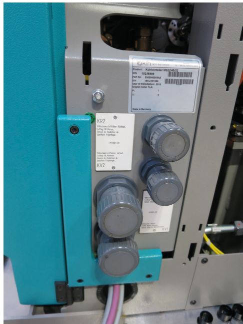
Bild 01: Kühlwasseranschlüsse an einem Mehrspindler
