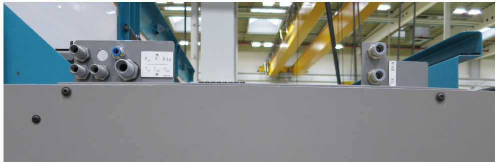
Bild 01: Beispiel: Fluidanschlüsse an einem Stangenlademagazin MBL
