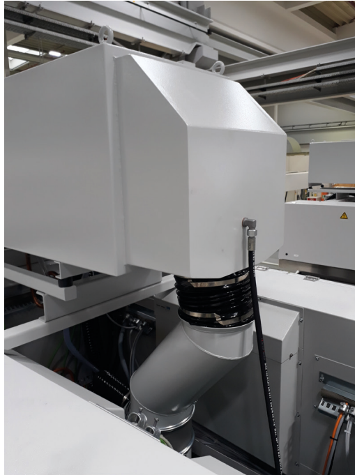
Bild 04: Anschluss des Löschmittelschlauches
