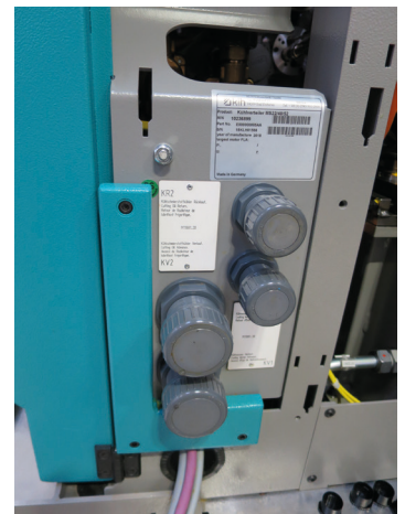
Bild 01 und 02: mechanische und fluidische Anbindungsstelle an einem Mehrspindler
