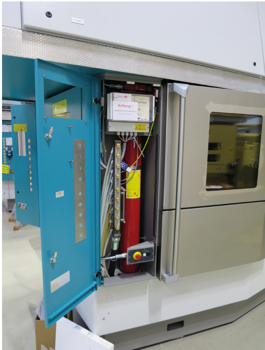
Bild 01: Serienmäßig montierte Feuerlöschanlage
