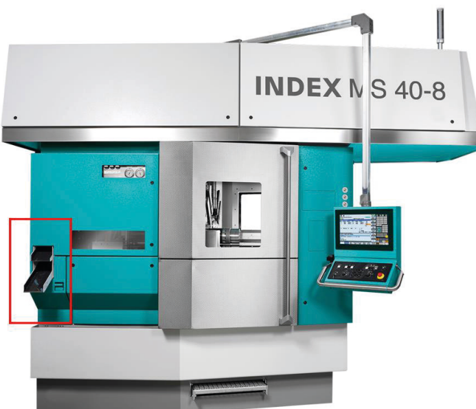
Bild 01: Beispiel MS40-8 Werkstückübergabestelle der Maschine
