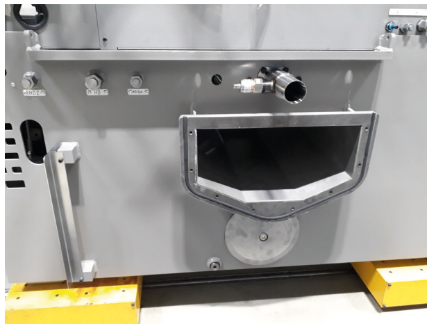
Bild 01 und 02: mechanische und fluidische Anbindungsstelle an einem Mehrspindler
